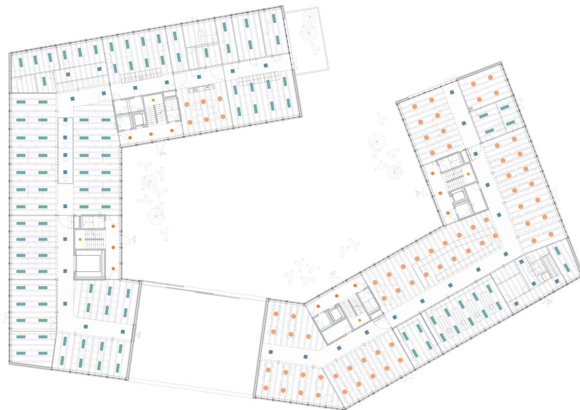
Lichtkonzept für das Erdgeschoss der neuen «Rhyboot»-Werkstätten
